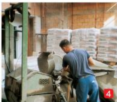
4) Příprava hmoty v kontinuální míchačce.
